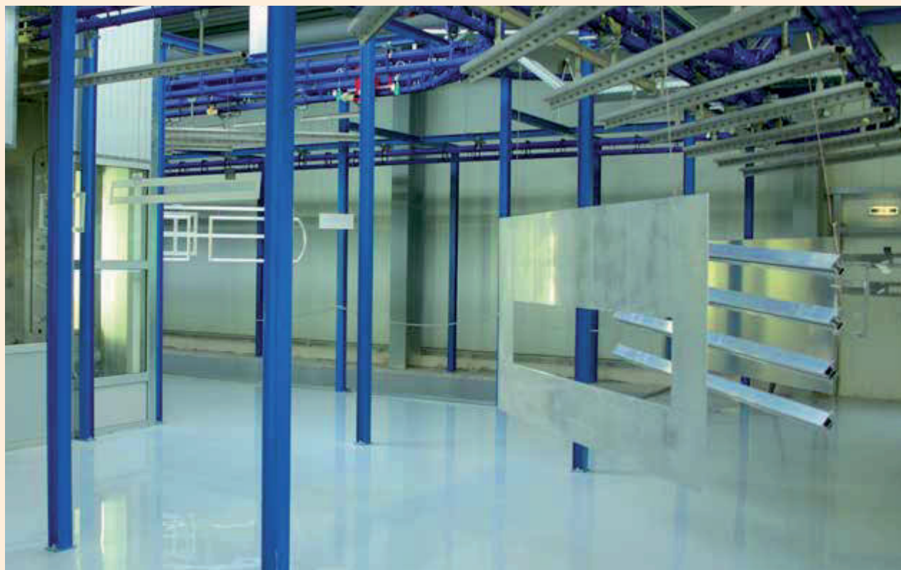
Aluminiumkomponenten auf dem Weg in die Pulverbeschichtungsanlage
